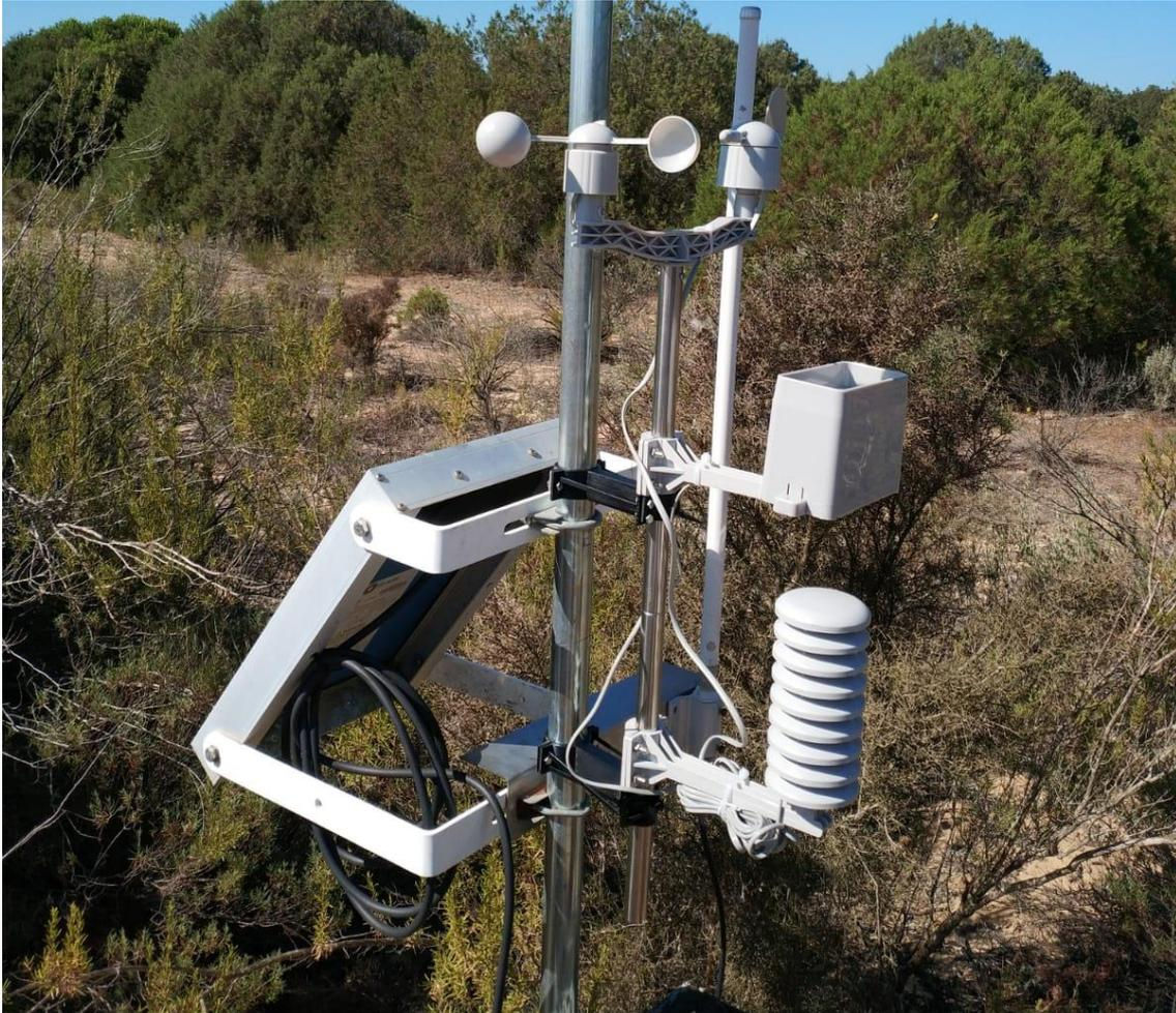
Figura 2. Instalación de nodo terminal (detalle de sensores méteo del nodo #10).
