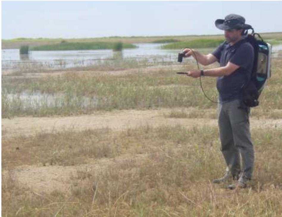
*Figura 2: Muestreo de radiometría sobre superficies naturales*
