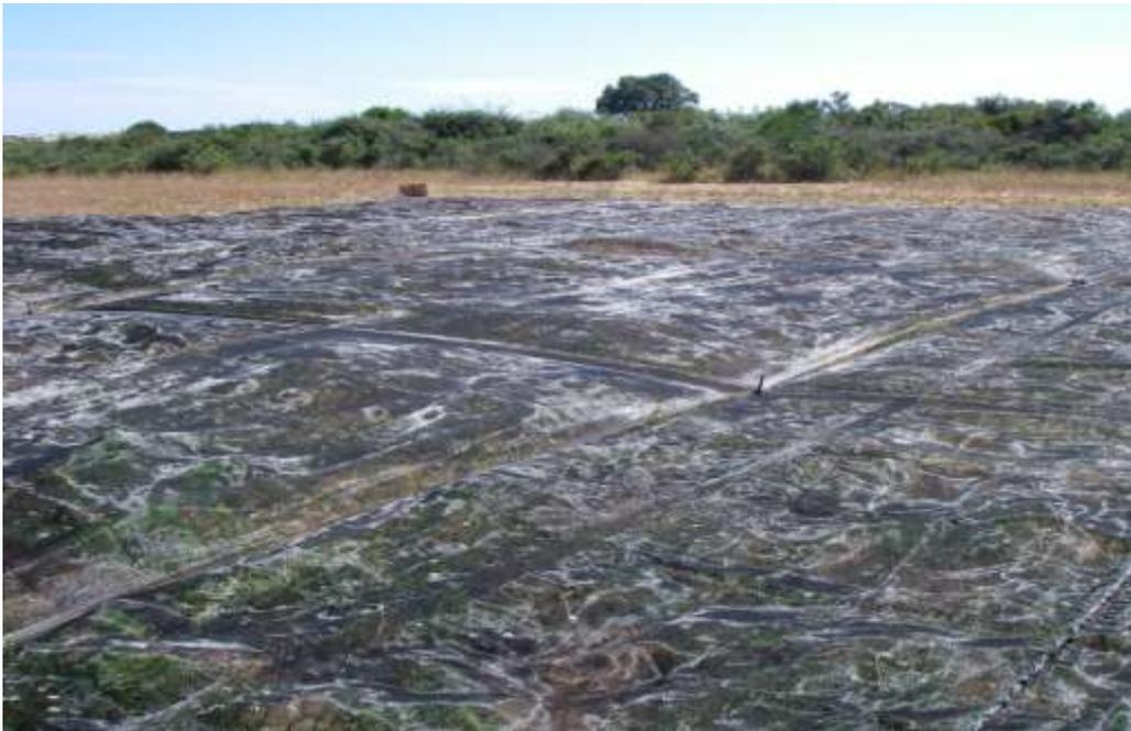
*Figura 5: Superficie artificial de referencia con reflectividad intermedia*
