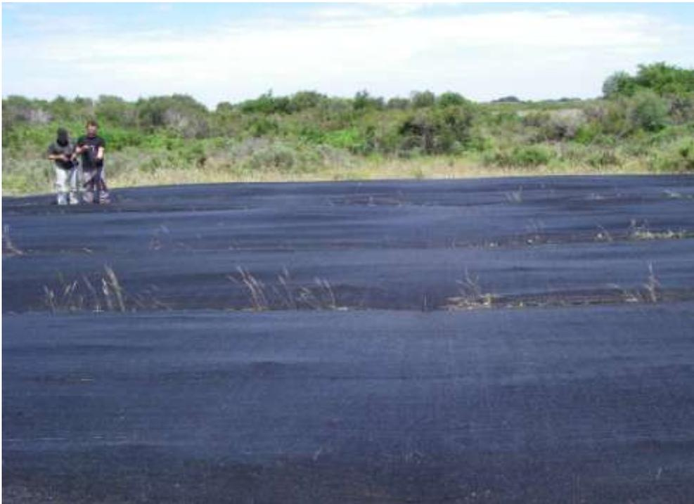
*Figura 3: Superficie artificial de referencia con reflectividad baja*
