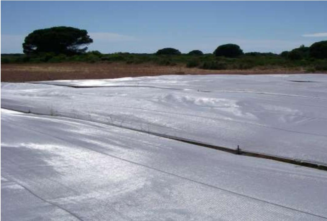
*Figura 4: Superficie artificial de referencia con reflectividad alta*
